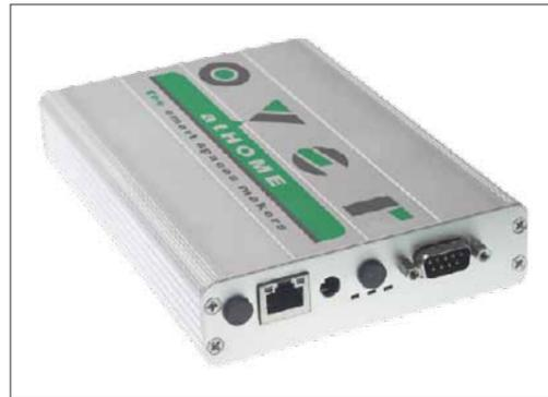
usare qualsiasi cavo unifilare per il bus e non per forza uno specifico come nel caso di KNX o SCS. Il nostro BUS viaggia su cavi unifilari normalissimi che possono viaggiare nello stesso tubo dei cavi 230V, così l'installatore non deve preoccuparsi di munirsi di un cavo particolare.
