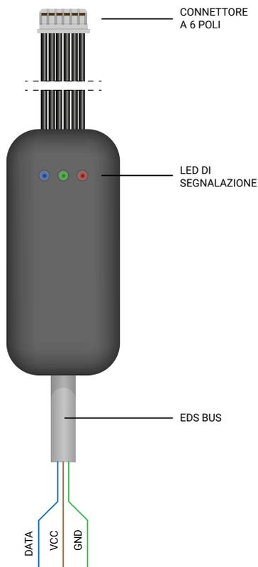
Il dispositivo è dotato di un connettore a sei poli posto sul lato superiore che permette l'interazione con il dispositivo ITC DAIKIN DSC601C71 (maggiori informazioni sulla procedura di collegamento nei prossimi capitoli).
