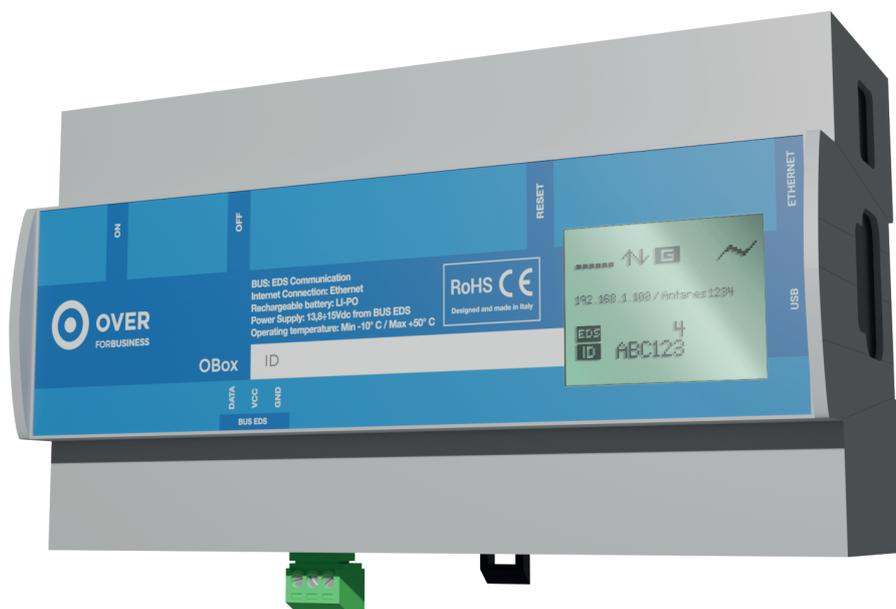
L'OBox è il gateway del sistema OVER che connette la rete dei dispositivi EDS dell'infrastruttura OVER con la piattaforma cloud, attraverso porta ETHERNET/LAN o SIM DATI. La connessione tra l'OBox e il cloud rispetta i più elevati requisiti di sicurezza informatica permettendo la comunicazione in rete locale anche in ambienti più sensibili come le banche. L'OBox è predisposto per il montaggio su guida DIN con spazio occupato di 9 moduli.
